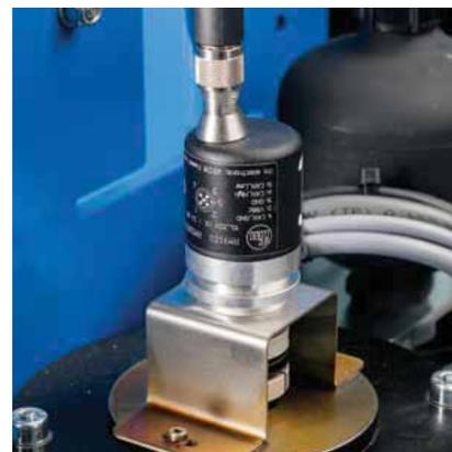
Линейное измерение с помощью счётчика: вращательное движение преобразуется в цифровые сигналы.
