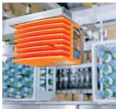
Контроль комплектности в процессе розлива с помощью efactor pmd3d.
