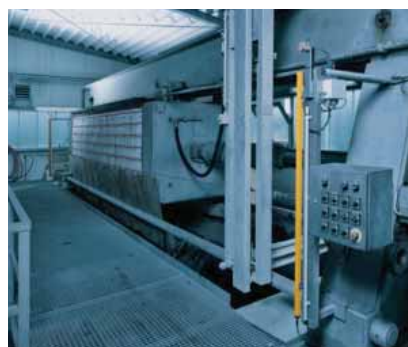
Контроль области с помощью многолучевых барьеров безопасности.
